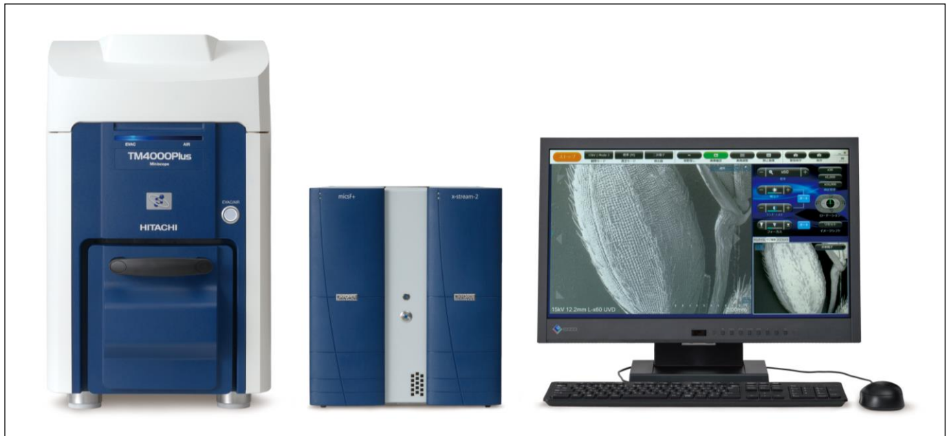
1. ábra – Hitachi TM4000II Plusz asztali pásztázó elektronmikroszkóp Oxford Instruments Xplore Compact 30 EDS detektorral felszerelve
