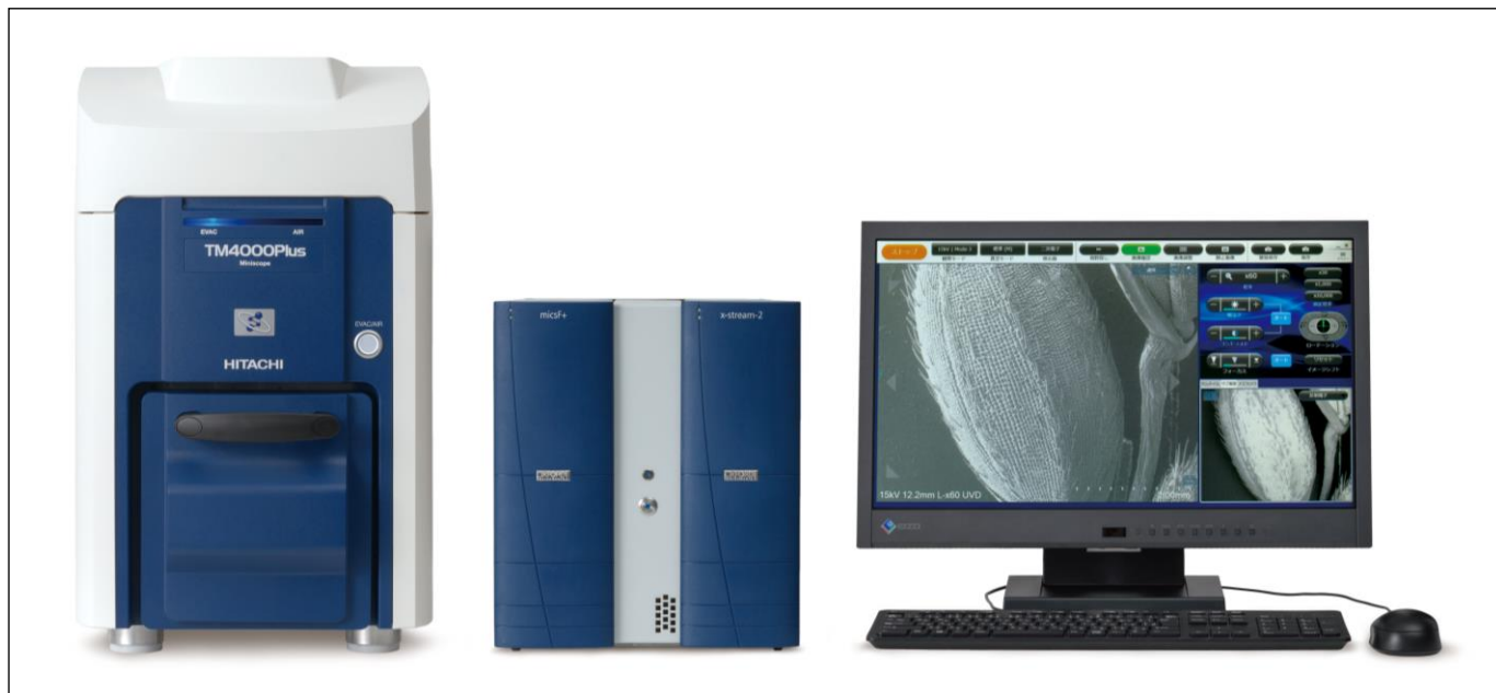
1. ábra – Hitachi TM4000II Plusz asztali pásztázó elektronmikroszkóp Oxford Instruments Xplore Compact 30 EDS detektorral felszerelve
