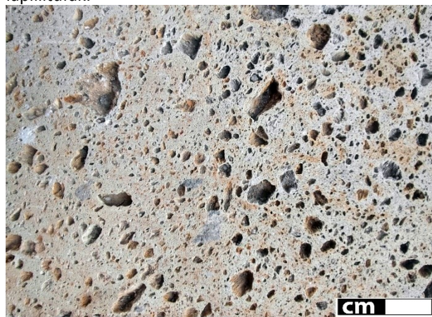
7. ábra: Hidrotermálisan bontott riolit lapillitufa (Mád), kimállott horzsa-kővel és litoklasztokkal
