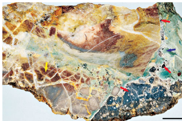
1. ábra – Peperit és hidraulikus breccsa. Piros nyíl: alsó-kréta alkálibazalt; kék nyíl: kimmeridge-i mészkő; sárga nyíl: oxfordi mészkő. K-Mecsek, Vár-völgy, Iharos-kút. Méretarány: 6 mm
