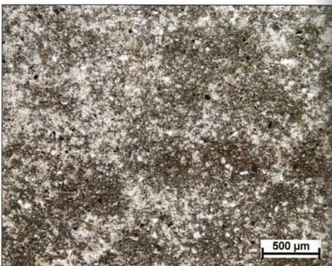
10. ábra – Az Erdélyi-középhegység D-i részéből származó hornfels tömb jellegzetes szöveti képe polarizációs mikroszkópban, 1nikol (Fhk-12/9 minta)
