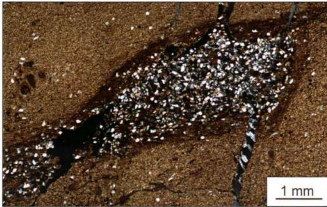
2. ábra – Nagy kvarctartalmú betelepülés mikrites dolomitban; Balatonakali, Bak7. vékonycsiszolat
