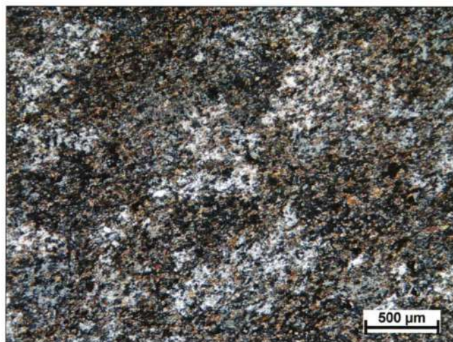
3. ábra – A hornfels kőszeközök jellegzetes szöveti képe polarizációs mikroszkópi kép, +nikol (GOR-221, Gorzsa, késő neolit)
